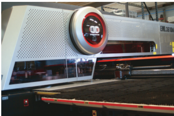
▲ L'EMLZ 3610NT permet un développement rapide des pièces de grandes séries en "tout automatique". L'ensemble des fonctions est piloté par le logiciel PN4000 de Wicam. ▼
