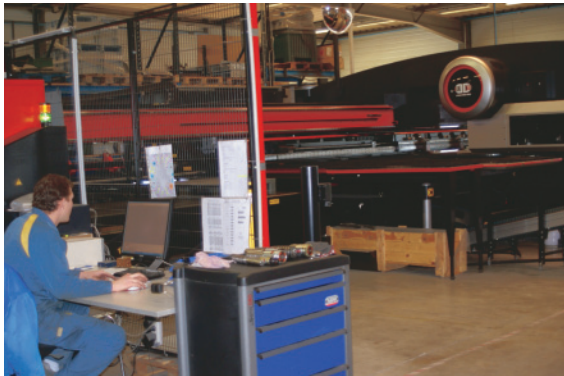
▲ L'EMLZ 3610NT permet un développement rapide des pièces de grandes séries en "tout automatique". L'ensemble des fonctions est piloté par le logiciel PN4000 de Wicam. ▼
